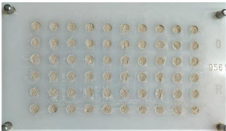
Abbildung 29: Kapselböden beim Abfüllvorgang.
