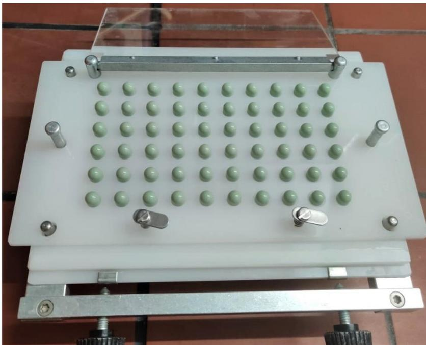
Abbildung 27: Deckelplatte zum Abheben der Kapseloberteile.
